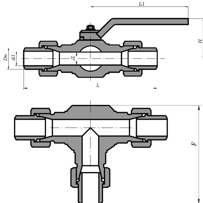
В таблице размеров представлены строительные длины серийных кранов. Размеры даны на краны с ручным управлением.
