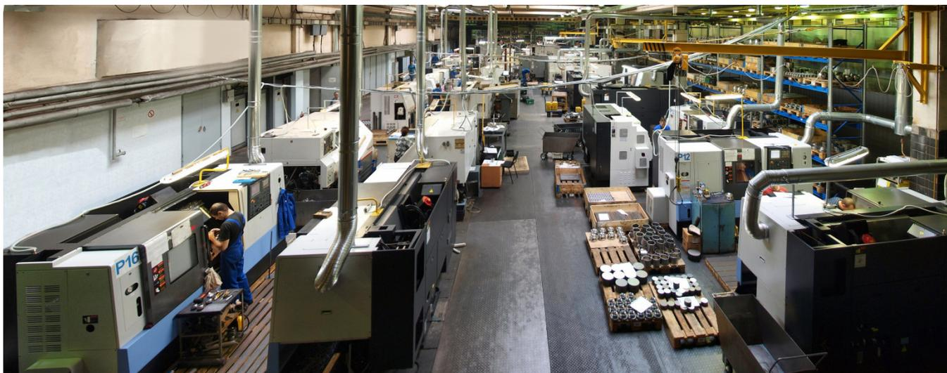
Предприятие оснащено современным станочным оборудованием, имеет замкнутый технологический цикл и выпускает более трех тысяч различных типоразмеров и модификаций кранов шаровых собственных разработок.
