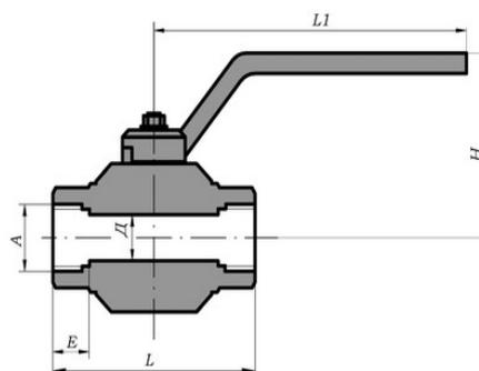
В серийном исполнении выпускается с двумя типами резьб: для PN до 200 кгс/см<sup>2</sup> – трубная цилиндрическая по ГОСТ 6357; для PN 200 и более – трубная коническая по ГОСТ 6211. Размеры даны на краны с ручным управлением.
