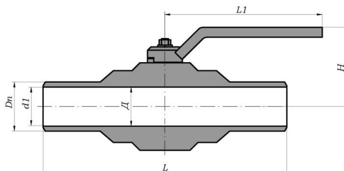
Размер патрубка и разделка кромок под приварку производится под трубу заказчика.
